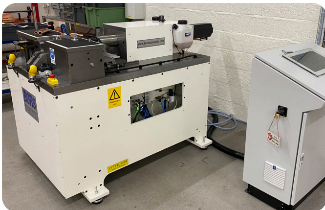
Anlage zum Umformen von Rohrenden in unserer Produktionsanlage.
