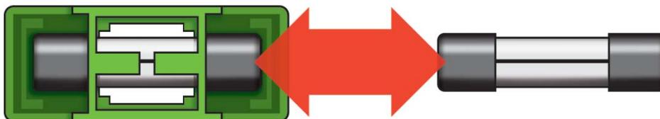
Die Feinsicherung nun seitlich aus dem Halter schieben. Der Einbau des Sicherungseinsatzes erfolgt in umgekehrter Reihenfolge. Besorgen Sie umgehend eine neue Reservesicherung!
